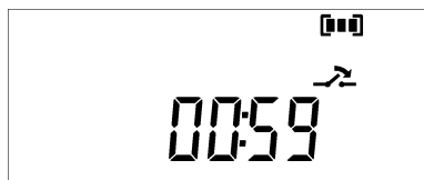
Рисунок А.7 – Пример индикации обратного отсчета до включения УКН
