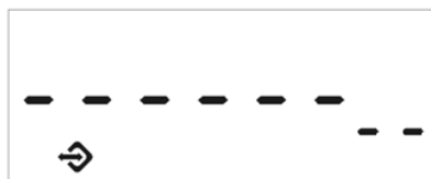
Рисунок Б.34 – Пример индикации при отсутствии связи ДД (превышено расстояние до ДИЭ, отсутствует напряжение на ДИЭ или ДИЭ неработоспособен вследствие аппаратного или программного сбоя) и связь до этого не осуществлялась (все символы будут мигать)
