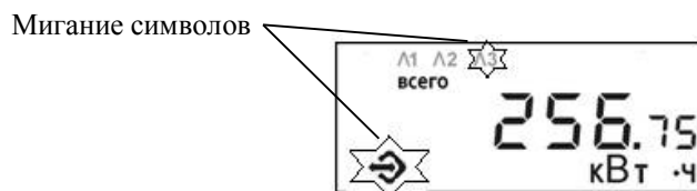
Рисунок А.53 - Пример индикации суммарной активной энергии при отсутствии связи ДД со счетчиком по фазе Л3, но с которым ранее осуществлялась связь
